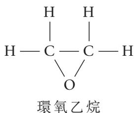
生產環氧乙烷用的原料是乙烯，乙烯可從石油的烴經裂解而獲取。
