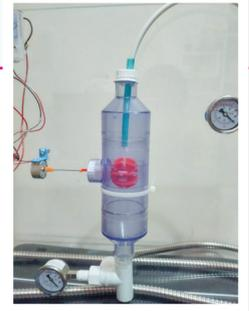
受陽光照射，配水管水溫上升餘氯減少，令水中病毒加速滋生。閥內亦加入智能水溫感應編程裝置來推測水中餘氯含量。當水溫升至高風險水平時會發出警報，提醒我們不要直接飲用食水。
