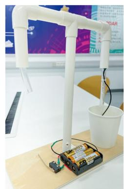
「微型添水器」的設計旨在讓學生可以在課室內隨時輕鬆添水。作品的原理是當使用者用杯子觸碰電路開關時，水泵電機便會啟動，將容器內的水抽出，經由水管流出到杯子中。當使用者拿走杯子時，水泵電機便會停止運作。
